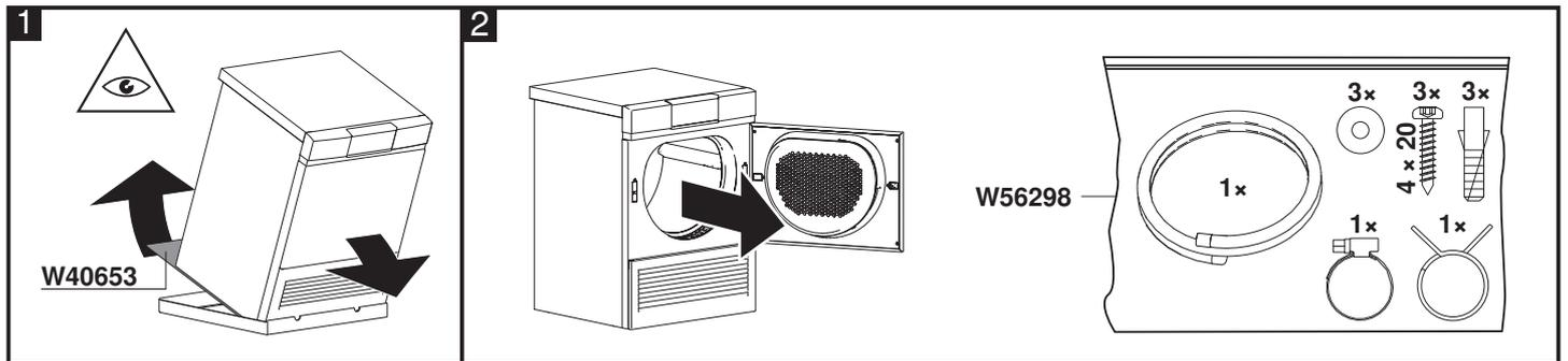
Chapitre 3a - Fixer la plaque d'installation au sol (appareil indépendant)
