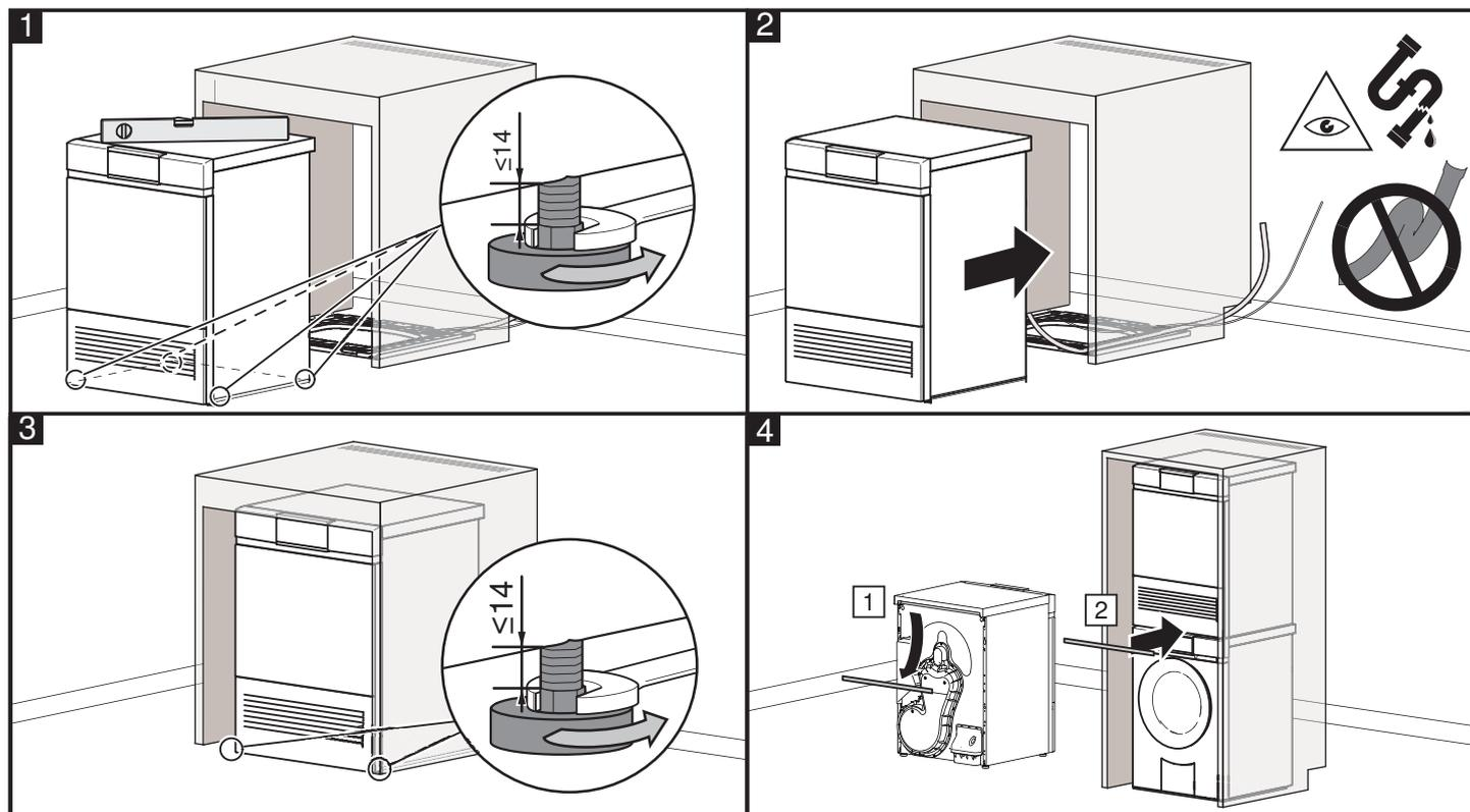
**!** L'appareil doit être d'aplomb avec ses 4 pieds sur la plaque d'installation et doit être stable.
