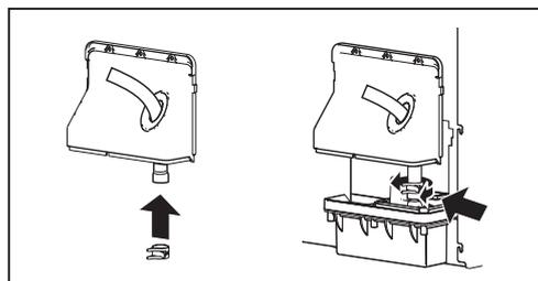
Raccorder le tuyau d'écoulement
